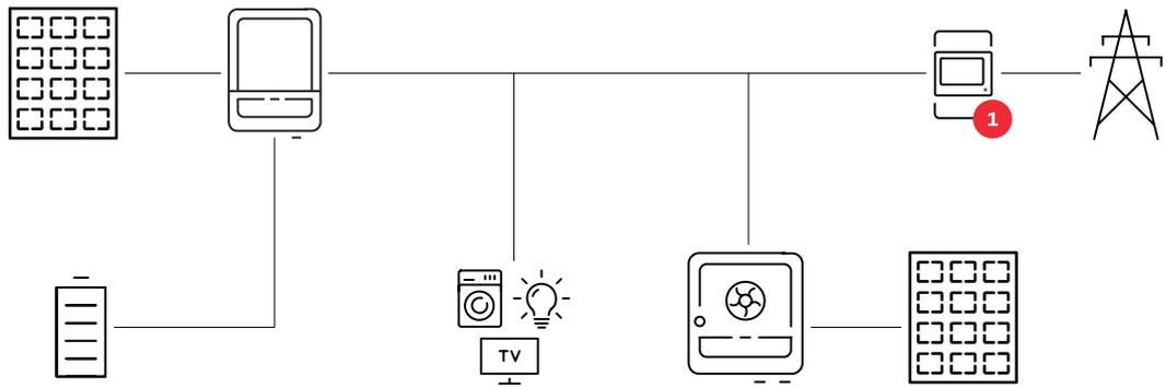
**Betriebsmodus - Wechselrichter mit Batterie, weiterem Wechselrichter und Notstrom-Funktion**
