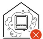
Der Wechselrichter ist staubdicht (IP 66) ausgeführt. In Bereichen mit starker Staubansammlung können sich Staubablagerungen auf den Kühlflächen ansammeln und somit die thermische Leistungsfähigkeit beeinträchtigen. In diesem Fall ist eine regelmäßige Reinigung erforderlich. Eine Montage in Räumen und Umgebungen mit starker Staubentwicklung ist daher nicht zu empfehlen.
