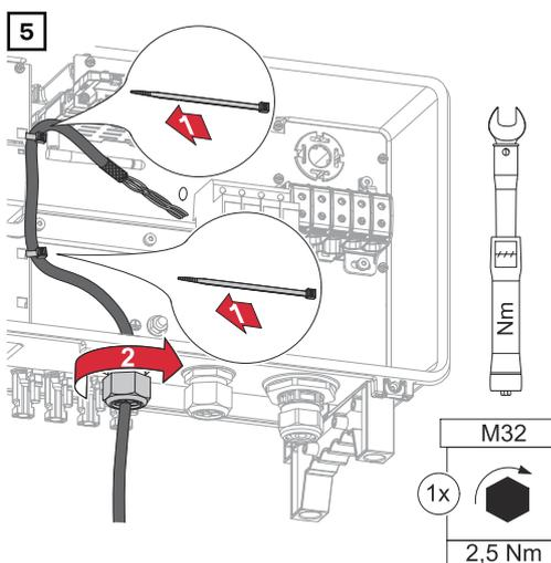
Datenkabel mit einem Kabelbinder an der Schutzabdeckung des Überspannungsschutzes DC SPD befestigen. Die Überwurfmutter der Kabelverschraubung mit einem Drehmoment von min. 2,5 - max. 4 Nm befestigen.
