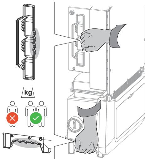
Seitlich am Wechselrichter befinden sich integrierte Haltegriffe, die das Anheben/Einhängen erleichtern.
