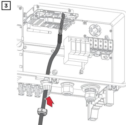
Datenkabel zuerst durch die Überwurfmutter der Kabelverschraubung und danach durch die Gehäuseöffnung führen.
