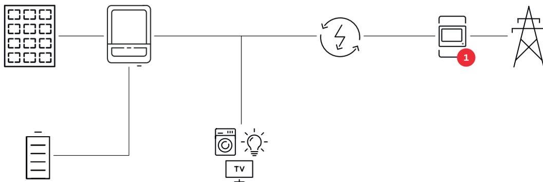
**Betriebsmodus - Wechselrichter mit Batterie und Ohmpilot**
