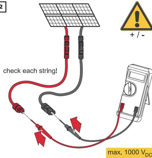
Mit einem geeigneten Messgerät die Spannung und Polarität der DC-Verkabelung überprüfen.
