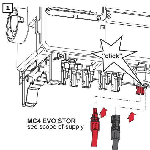
PV-Kabel von den Solarmodulen an den MC4 Steckern laut Beschriftung anschließen
