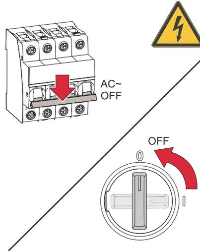
Den Leitungs-Schutzschalter ausschalten. Sicherstellen, dass sich der DC-Trenner in der Schalterstellung „Aus“ befindet.
