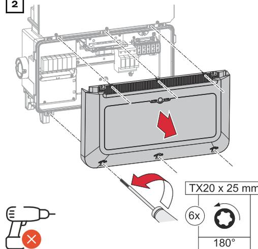
Die 6 Schrauben der Abdeckung des Anschlussbereichs mit einem Schraubendreher (TX20) und einer 180°-Drehung nach links lösen. Die Abdeckung des Anschlussbereichs vom Gerät nehmen.
