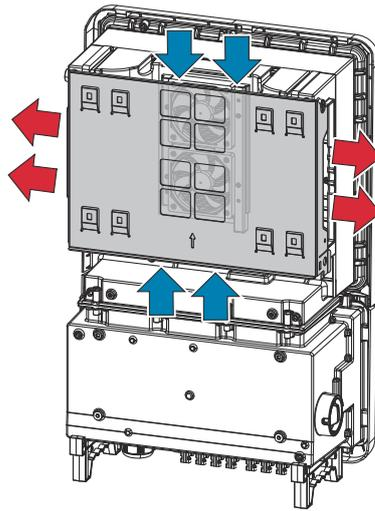
Umgebungsluft wird vom Lüfter an der Ober- und Unterseite angesaugt und an den Geräteseiten ausgeblasen. Die gleichmäßige Abfuhr der Wärme ermöglicht die Installation von mehreren Wechselrichtern nebeneinander.
