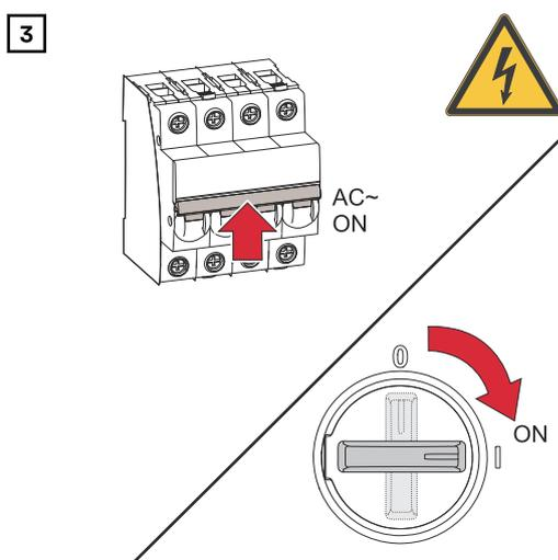
Den DC-Trenner auf Schalterstellung „Ein“ schalten. Den Leitungs-Schutzschalter einschalten.
