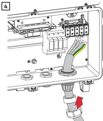
Mehr Informationen zur Kabelverschraubung siehe Kapitel [Kabeldurchmesser des AC-Kabels](#) auf Seite 66.
