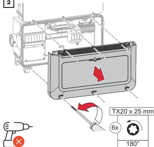
Die 6 Schrauben der Abdeckung des Anschlussbereichs mit einem Schraubendreher (TX20) und einer 180°-Drehung nach links lösen.
