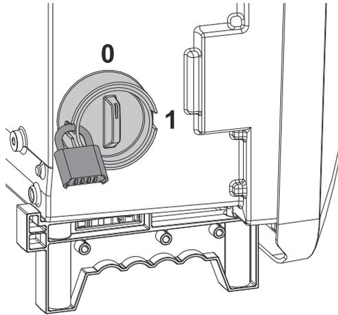
Der DC-Trennschalter verfügt über 2 Schalterstellungen: Ein / Aus.
