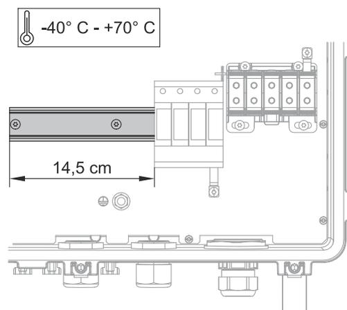
Im Anschlussbereich steht Platz für die Montage von Drittanbieter-Komponenten zur Verfügung. Auf der Hutschiene können Komponenten bis zu einer maximalen Breite von 14,5 cm (8 TE) montiert werden. Die Komponenten müssen eine Temperaturbeständigkeit von  $-40^{\circ}\text{C}$  bis  $+70^{\circ}\text{C}$  aufweisen.
