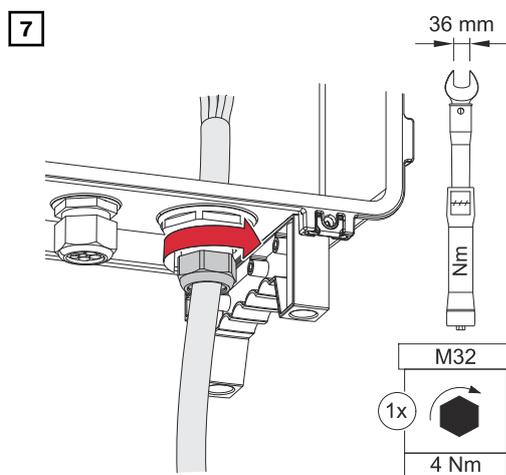
Die Überwurfmutter der Kabelverschraubung mit einem Drehmoment von 4 Nm befestigen.
