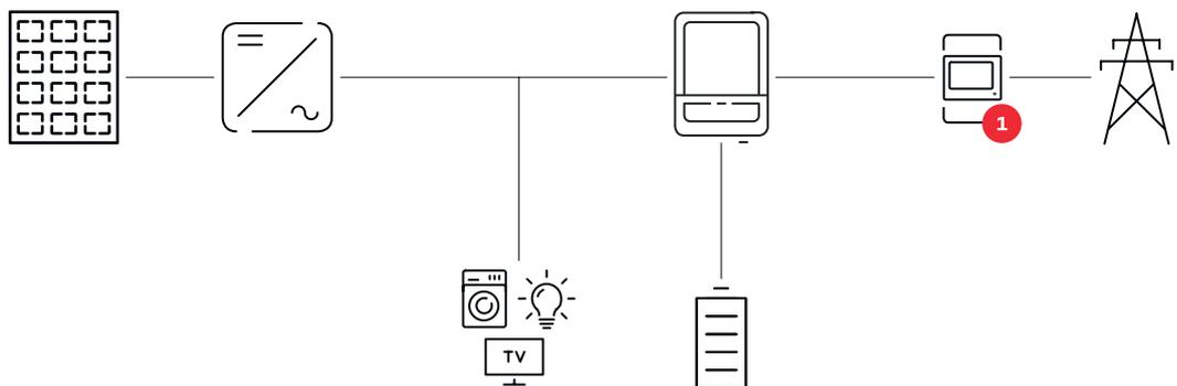
**Betriebsmodus - Wechselrichter mit Batterie und Notstrom-Funktion**
