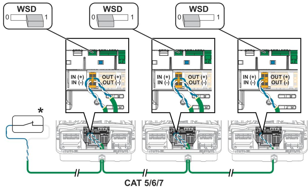
\* Potentialfreier Kontakt der Auslöseeinrichtung (z. B. zentraler NA-Schutz). Wenn mehrere potentialfreie Kontakte in einer WSD-Kette verwendet werden, sind diese in Serie zu verschalten.
