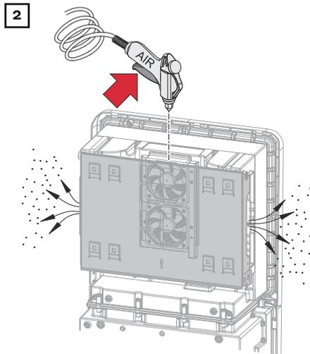
Die Schmutzablagerungen am Kühlkörper und Lüfter mit Druckluft oder einem Tuch oder einem Pinsel entfernen.
