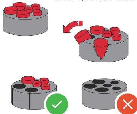
Den Dichtungsring an der Stelle, an welcher der Blindstopfen entfernt werden soll, aufspreizen.
