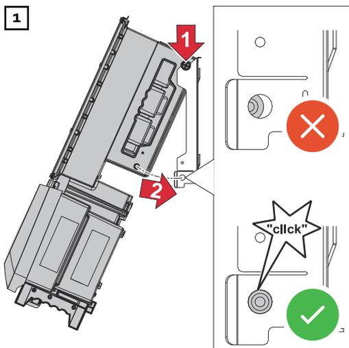
Den Wechselrichter von oben in die Montagehalterung einhängen. Die Anschlüsse müssen dabei nach unten zeigen.
