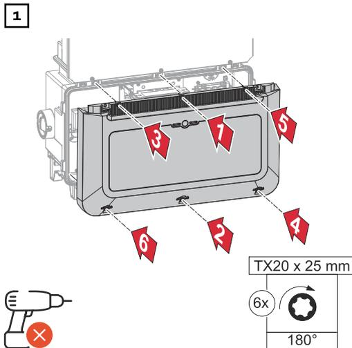
Die Abdeckung auf den Anschlussbereich setzen. Die 6 Schrauben mit einem Schraubendreher (TX20) und einer 180°-Drehung nach rechts befestigen.
