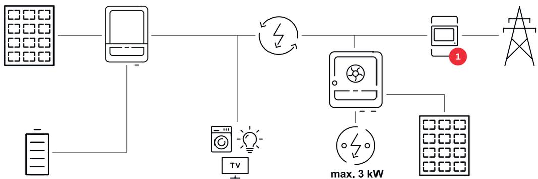
**Energiefluss-Richtung des Wechselrichters**
