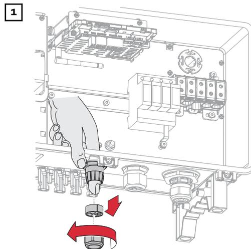
Überwurfmutter der Kabelverschraubung lösen und den Dichtungsring mit den Blindstopfen von der Innenseite des Geräts herausdrücken.
