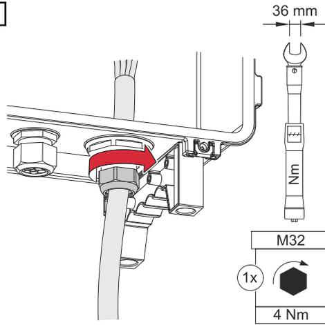
Die Überwurfmutter der Kabelverschraubung mit einem Drehmoment von 4 Nm befestigen.
