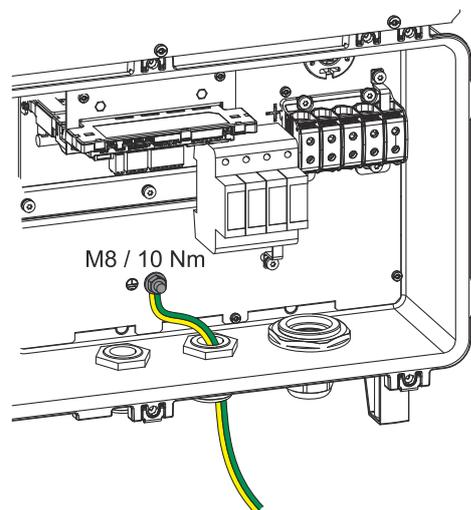
Der Erdungselektroden-Bolzen  $\oplus$  bietet die Möglichkeit, weitere Komponenten zu erden, wie z. B.:
