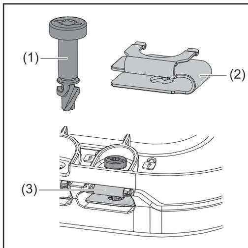
Zur Montage des Anschlussbereich-Deckels sowie des Frontdeckels wird ein Schnellverschluss-System (3) eingesetzt. Das Öffnen und Schließen des Systems wird mit einer halben Umdrehung (180°) der Schraube mit Verliersicherung (1) in die Schnellverschluss-Feder (2) realisiert.
