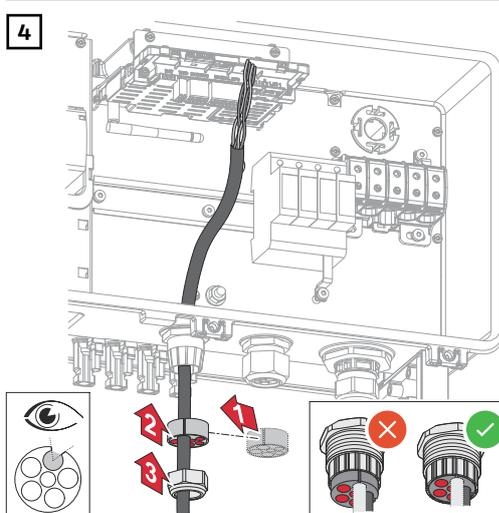
Dichtungsring zwischen der Überwurfmutter und der Gehäuseöffnung einsetzen. Die Datenkabel in die Kabelführung der Dichtung eindrücken. Danach die Dichtung bis zur Unterkante der Kabelverschraubung hineindrücken.
