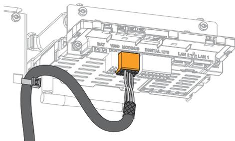
Die Kabel in den jeweiligen Steckplatz stecken und den Halt der Kabel prüfen.
