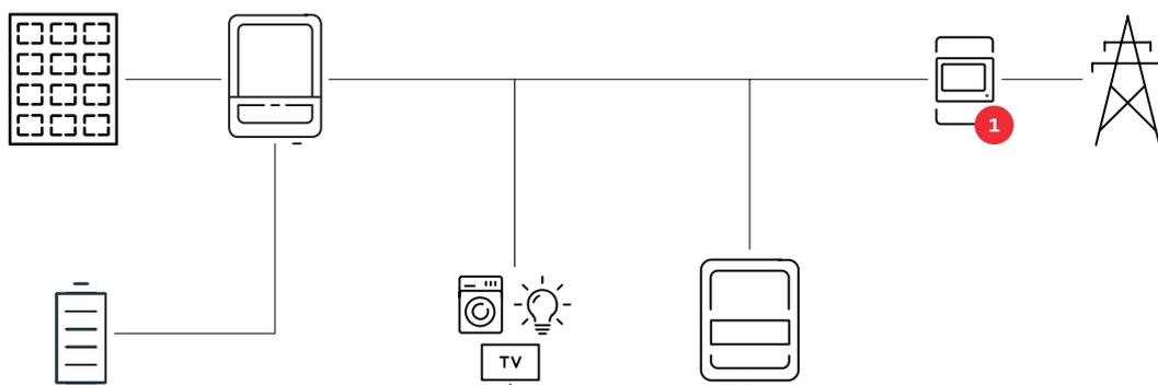
**Betriebsmodus - Wechselrichter mit Batterie, Ohmpilot und Notstrom-Funktion**
